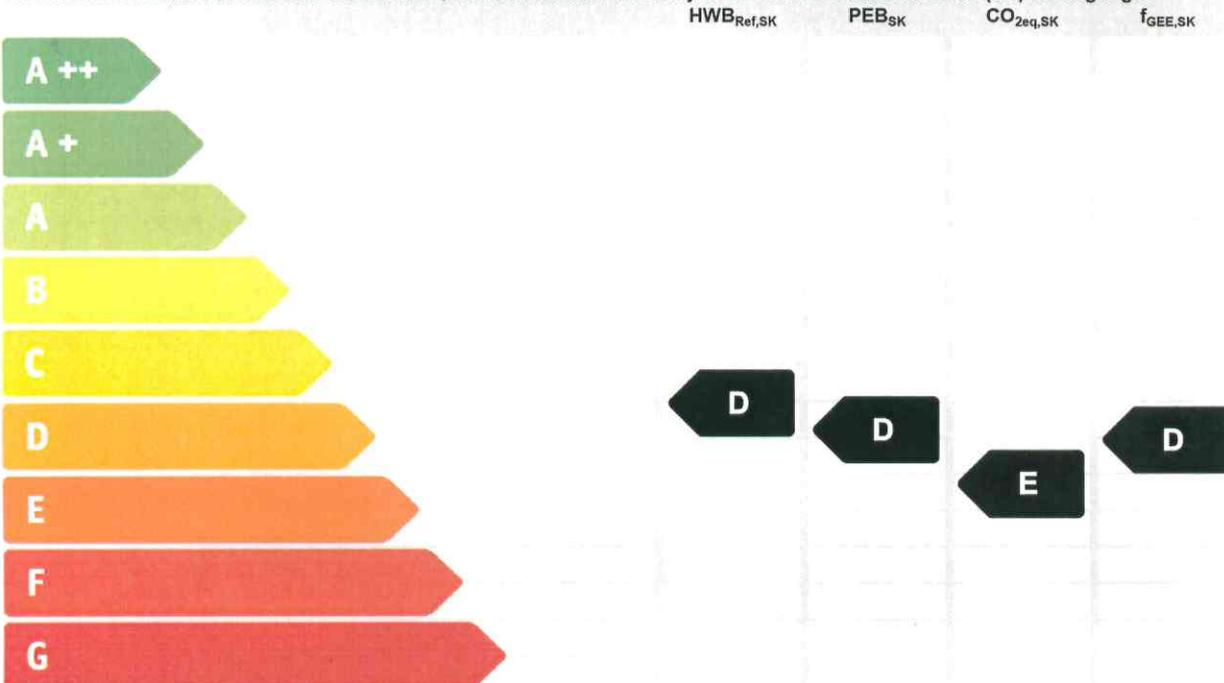
**HWB<sub>Ref</sub>:** Der Referenz-Heizwärmebedarf ist jene Wärmemenge, die in den Räumen bereitgestellt werden muss, um diese auf einer normativ geforderten Raumtemperatur, ohne Berücksichtigung allfälliger Erträge aus Wärmerückgewinnung, zu halten.
