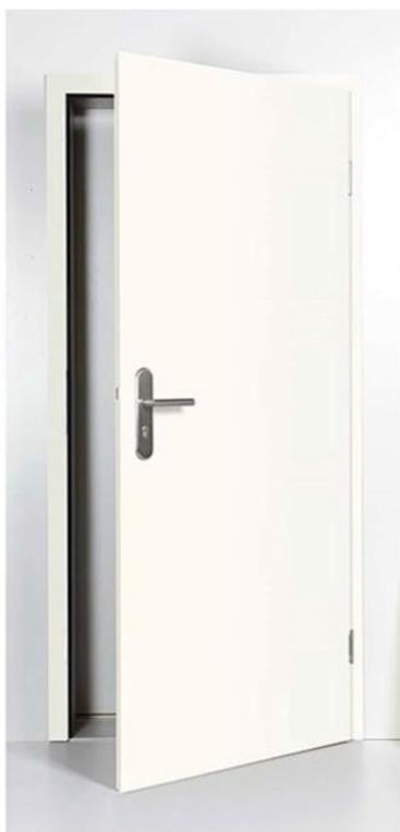
Oberfläche kunststoffbeschichtet bzw. weiß lackiert, in 2-färbig gestrichener Doppelfalzstahlzarge versetzt, mit 4-seitig umlaufender Dichtung sowie in einbruchhemmender Ausführung der Klasse RC 3 auszuführen. Anforderungen der Druckbelüftungsanlage sind bei der Wohnungseingangstür zu berücksichtigen. Zylinderschloss, Türspion mit Namensschild.
